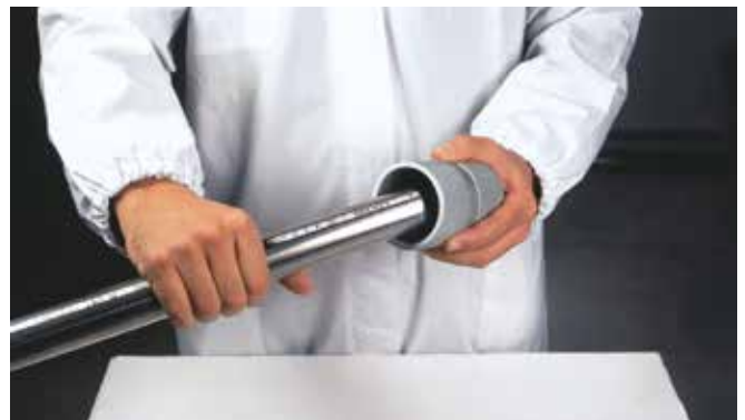
Bilde 26 – Avgrading av rør
