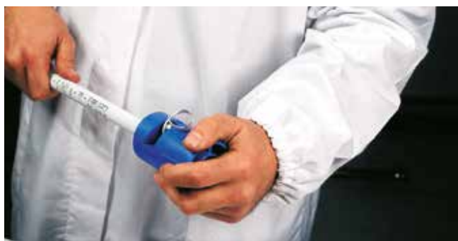
Bilde 29 - Stripping (steelPRES)
