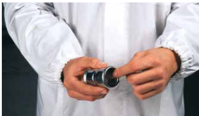
Bilde 30 - Kontroll av tetningsring
